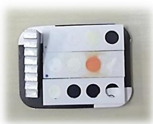
Figura 2. Sensor, placa de fósforo e amostras posicionadas para exposição radiográfica.
