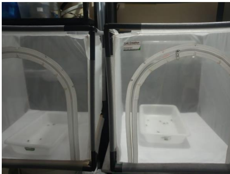
Figura 9 – Bioensaio: à direita, gaiola correspondente ao grupo tratamento (formigas em bandeja expostas ao forídeo solto, na proporção de cinco para um, por 90 minutos); à esquerda, gaiola correspondente ao grupo controle (formigas em bandeja mantidas sem forídeos pelo mesmo período).
