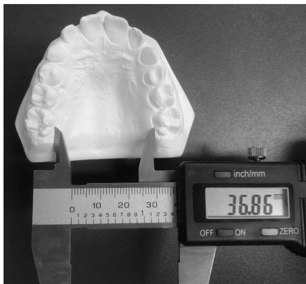
Figura 4: Mensuração da distância intermolares com paquímetro digital
