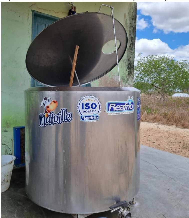
Anexo 14: Tanque de resfriamento da Natville com capacidade para 600 litros de leite
