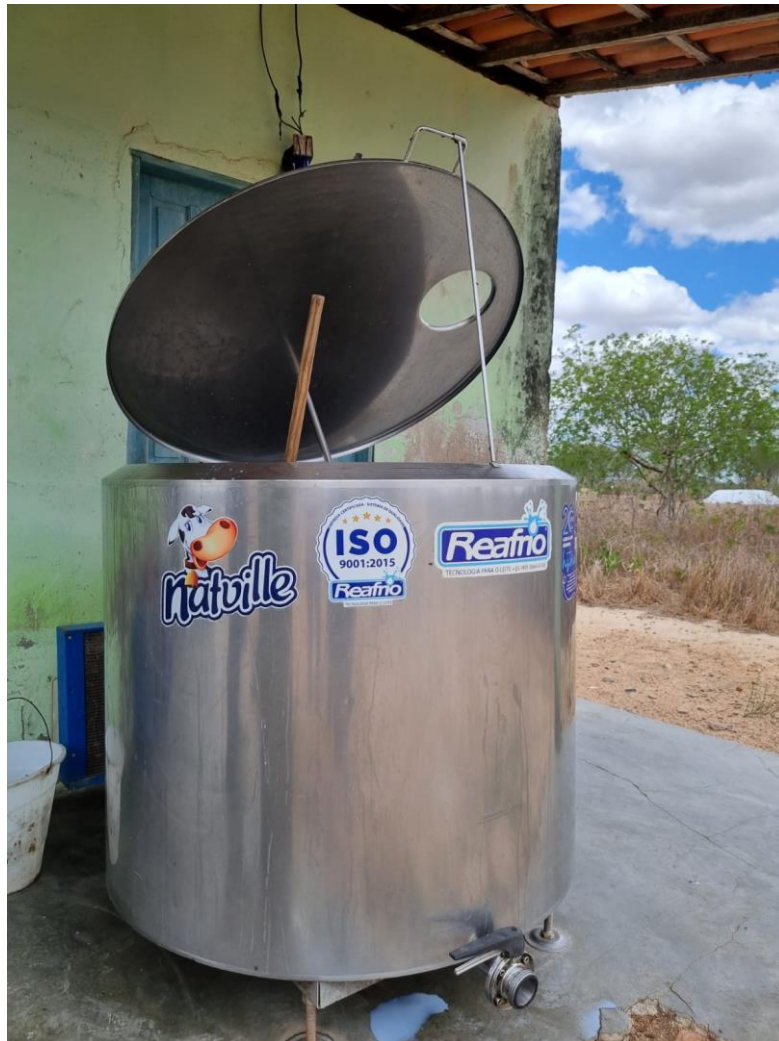
Figura 20: Tanque de resfriamento
