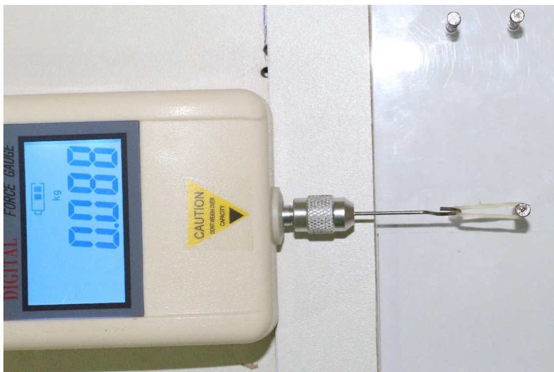
Figura 5. Força de tração do elástico mensurada pelo dinamômetro digital.
