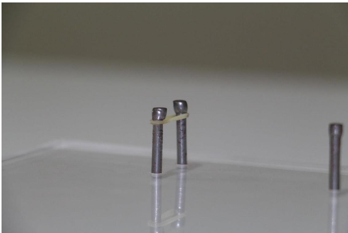
Figura 2. Elástico posicionado em parafusos estáveis presos placa de acrílico.
