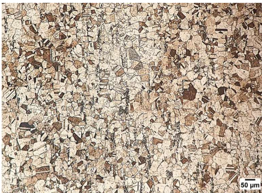
Figura 5.6: Micrografia do aço inoxidável 316L-R na condição como fabricado (amostra de referência).
