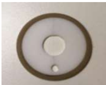
Figura 1: Matriz circular bipartida de teflon usada para confecção do corpo de prova.
