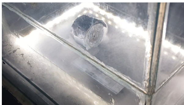
Figura 20 – Fonte de cézio-137 envolta na segunda construção da blindagem para colimação.
