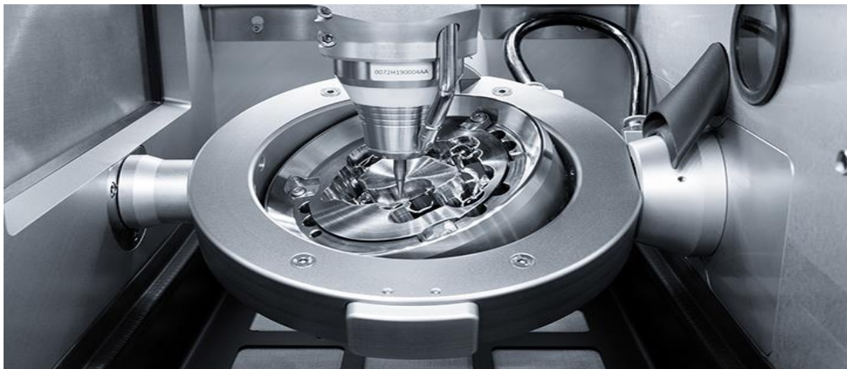
Figura 4. Característica da Fresadora M2 Wet Heavy Metal, mesa de trabalho giratória. Fonte: Catálogo do fabricante disponível em: https://www.zirkonzahn.com/pt/sistemas-cad-cam/fresadora-m2
