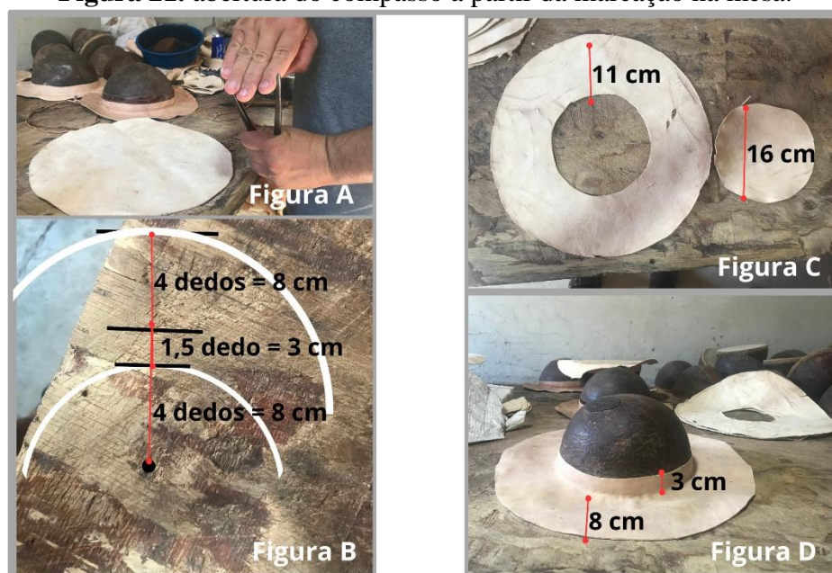
Figura 21. abertura do compasso a partir da marcação na mesa.
