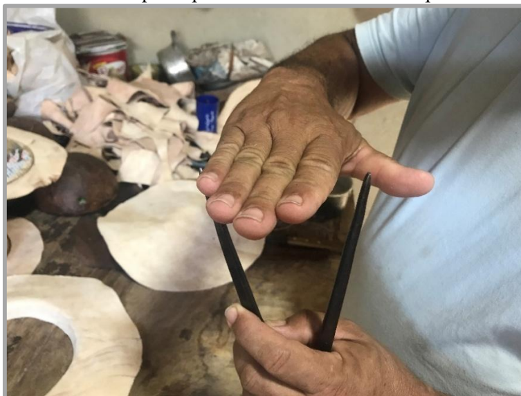
Figura 22. abertura do compasso para marcar o “S” de um chapéu forma tamanho 62.
