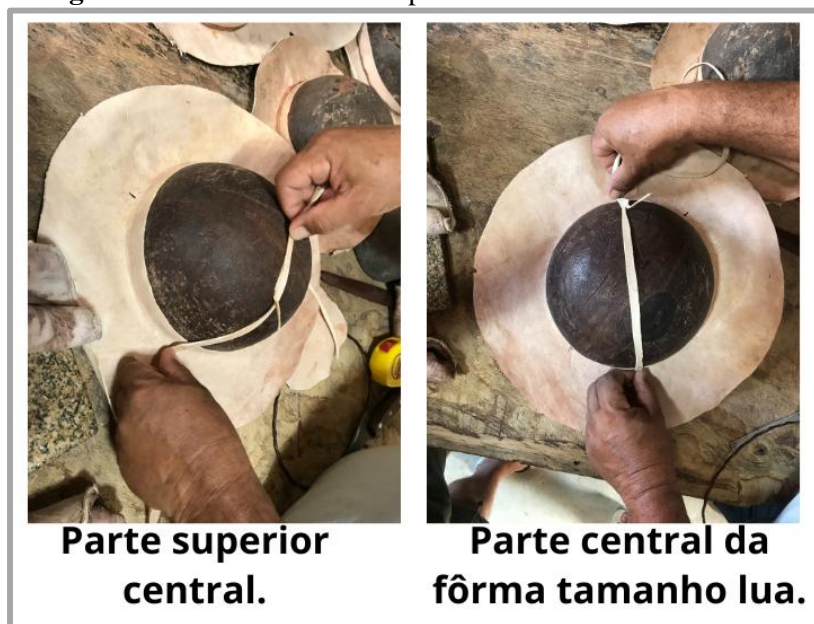
Figura 20. Cálculo da medida para encontrar a altura da forma.
