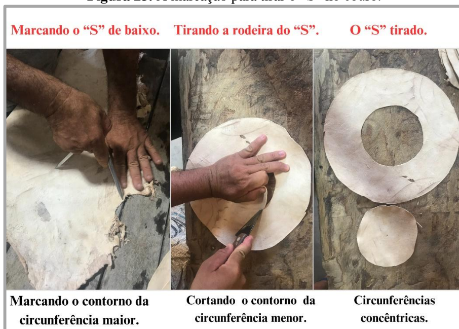
Figura 23. A marcação para tirar o “S” no couro.
