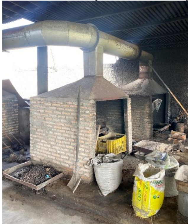
Figura 6: Forno com filtro utilizado para torrar a castanha na cooperativa
