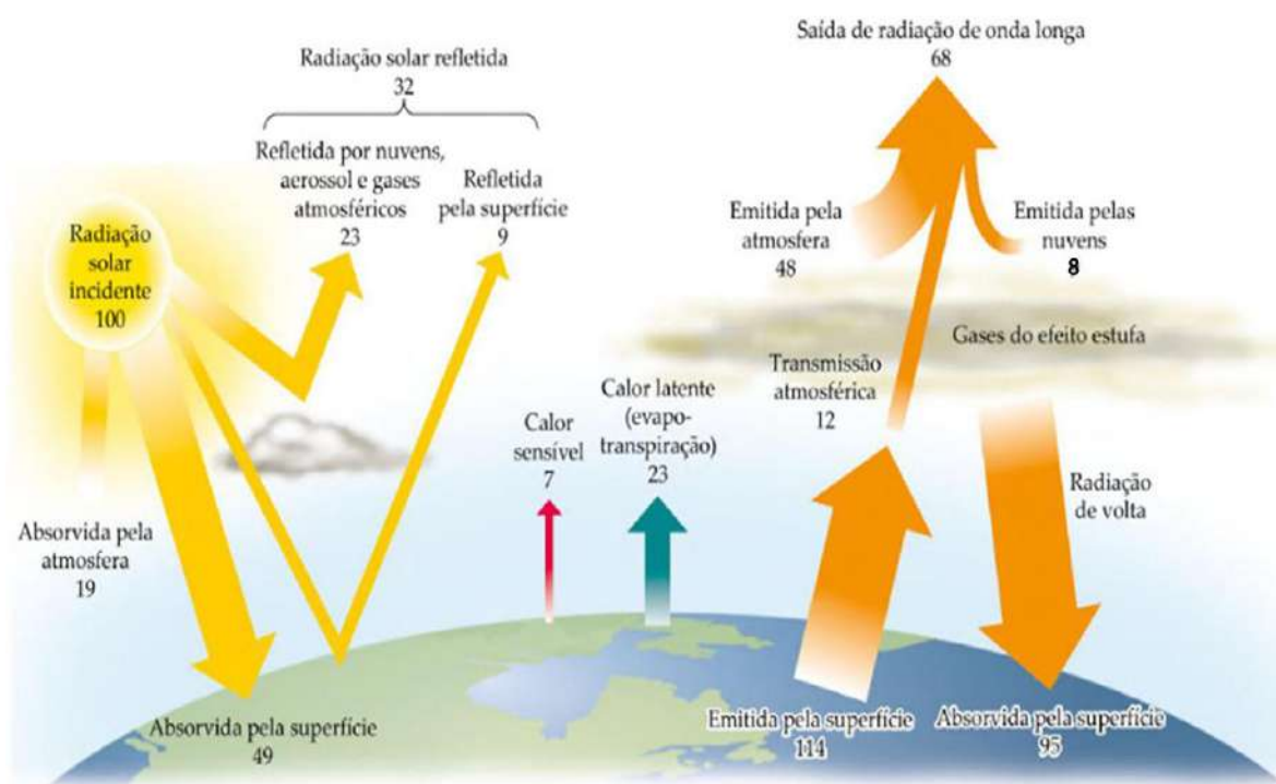
Figura 18 – Balanço de energia solar no sistema Terra-atmosfera.
