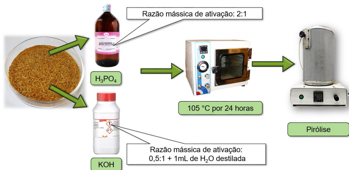
Figura 16 – Esquema de ativação da biomassa de coco verde pré-pirólise.
