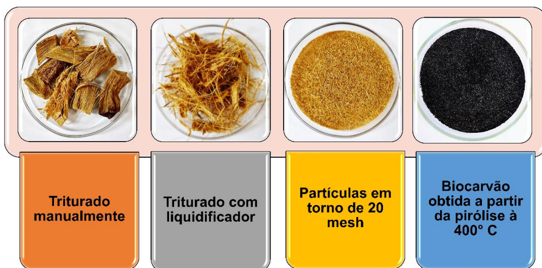
Figura 14 – Imagens da biomassa após cada etapa do pré-tratamento físico, e após a pirólise.
