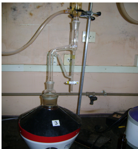
FIGURA 3A. Hidrodestilação em aparelho tipo Clevenger. São Cristóvão, UFS, 2008.
