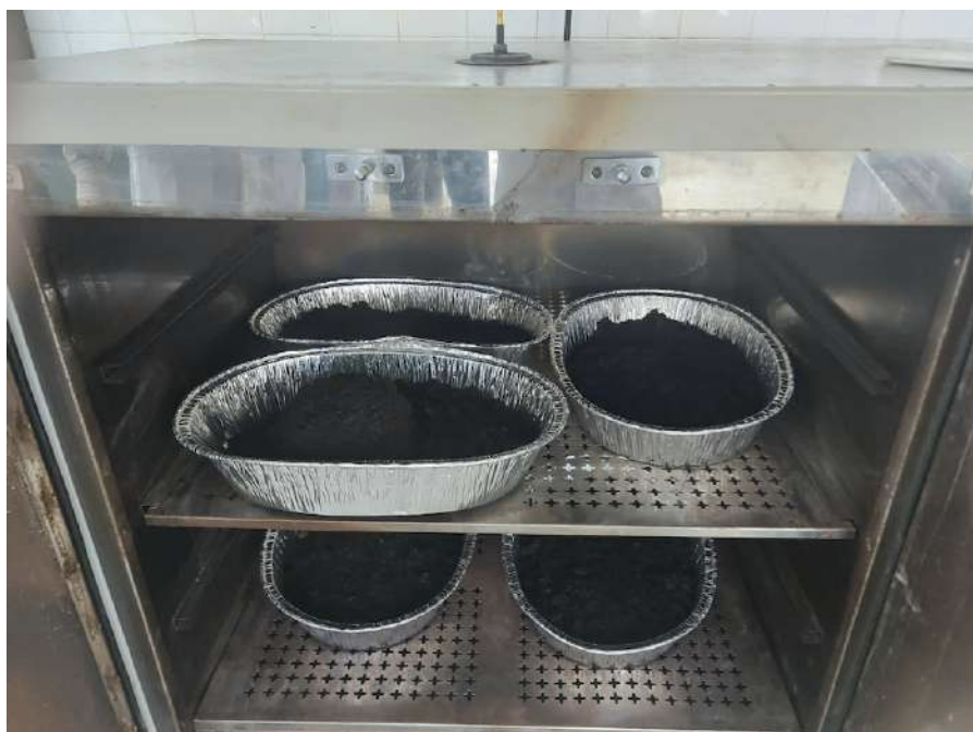
Figura 4 - Secagem do lodo em estufa à 100°C
