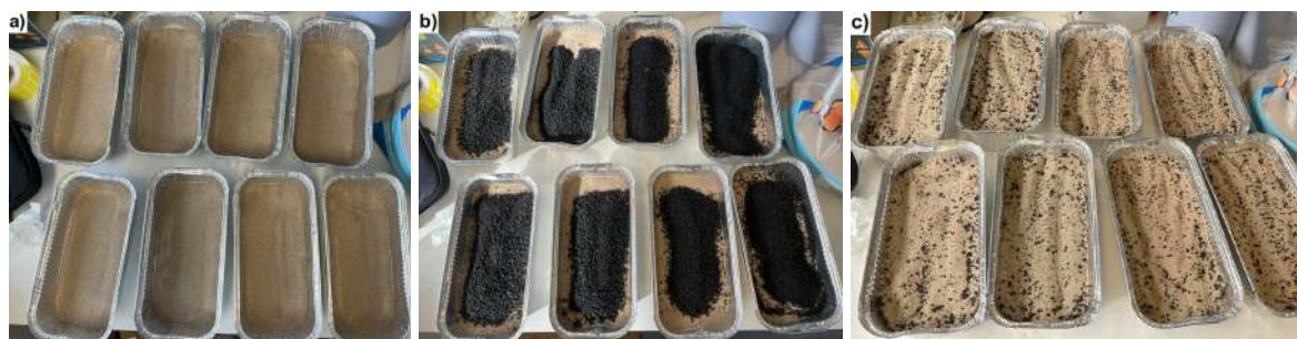
Figura 13 - Preparação das misturas areia-biocarvão para indução do envelhecimento acelerado, (a) areia de granulometria média, (b) adição de biocarvão (5% em massa) e (c) mistura homogênea de areia e biocarvão
