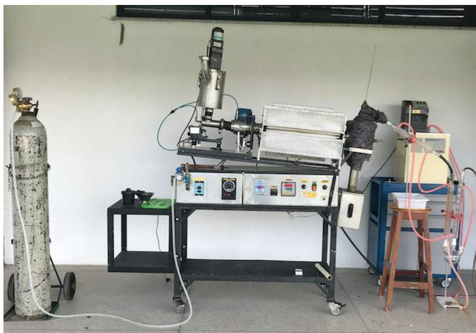
Figura 6 - Forno rotativo utilizado para produção do biocarvão de lodo
