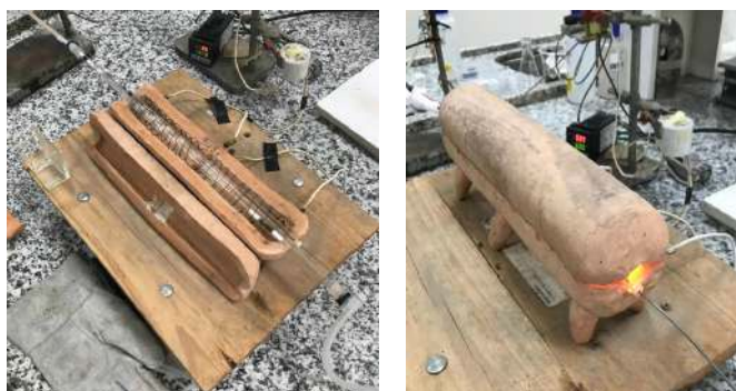
Figura 7 - Micro reator utilizado para produção de biocarvão de lodo à 400, 500 e 600 °C
