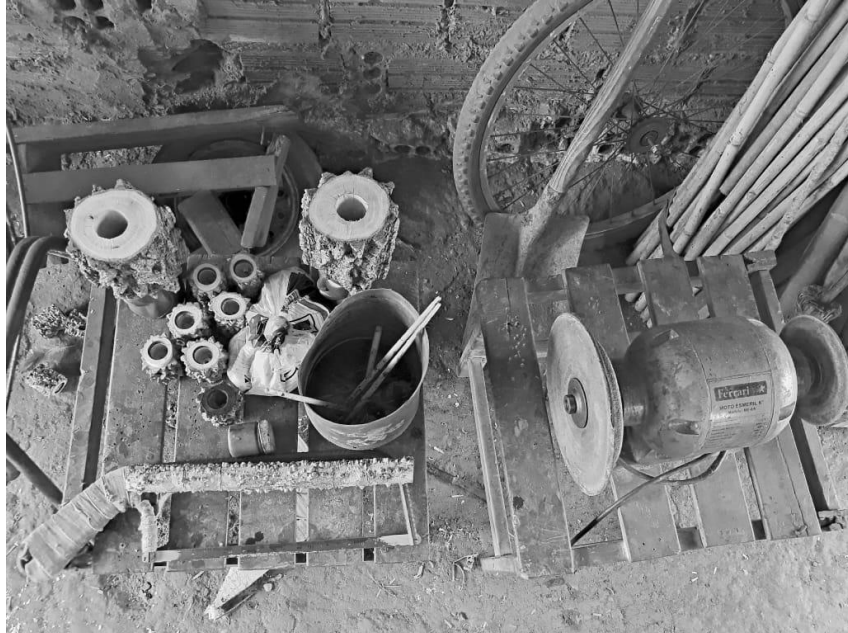
Fotografia 9 – Fornilhos, haste, pincéis, tinta e máquina de polimento
