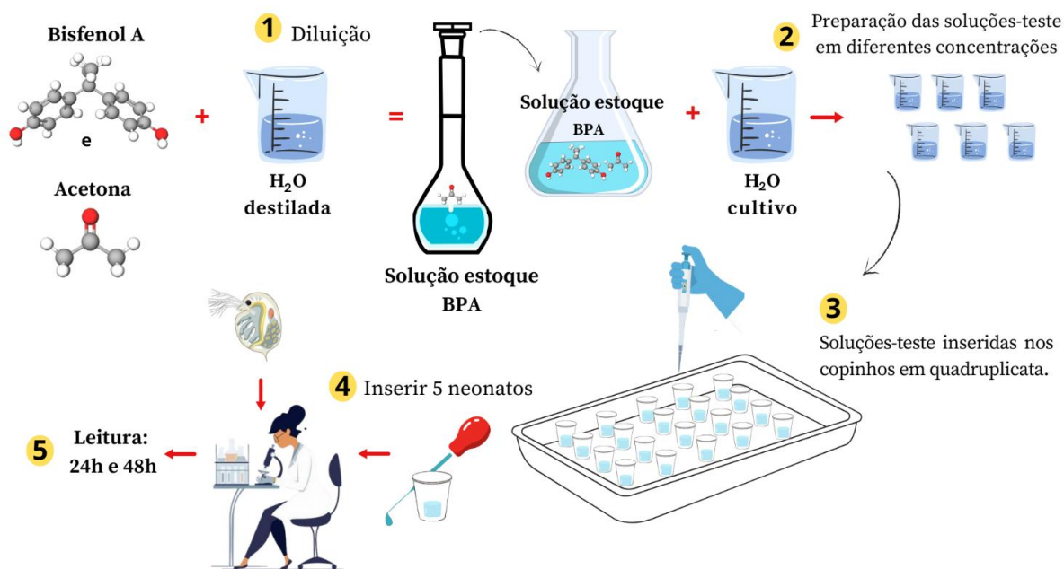
Figura 8 - Ilustração da metodologia do teste de toxicidade aguda com os organismos-teste: D. similis e C. silvestrii .
