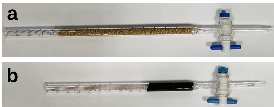
Figura 4 – Colunas de adsorção em leito fixo com os materiais adsorventes BMIG (a) e BMIGA (b).
