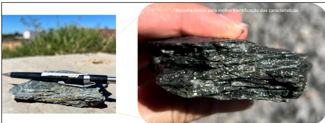
Figura 17 - SDQX foliado com bandas finas de quartzo e py fina disseminada e euédrica bandada.
