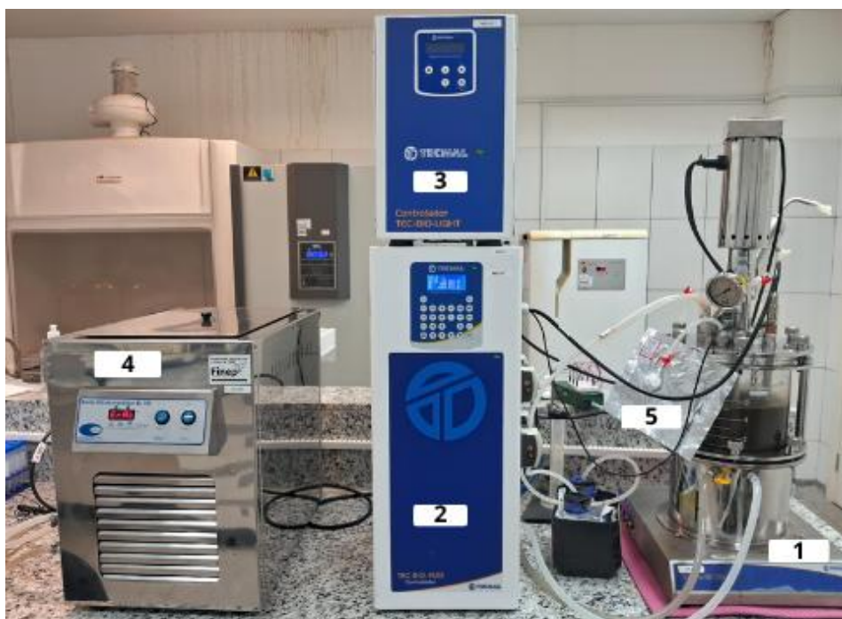
Figura 6- Sistema completo do biorreator anaeróbio.
