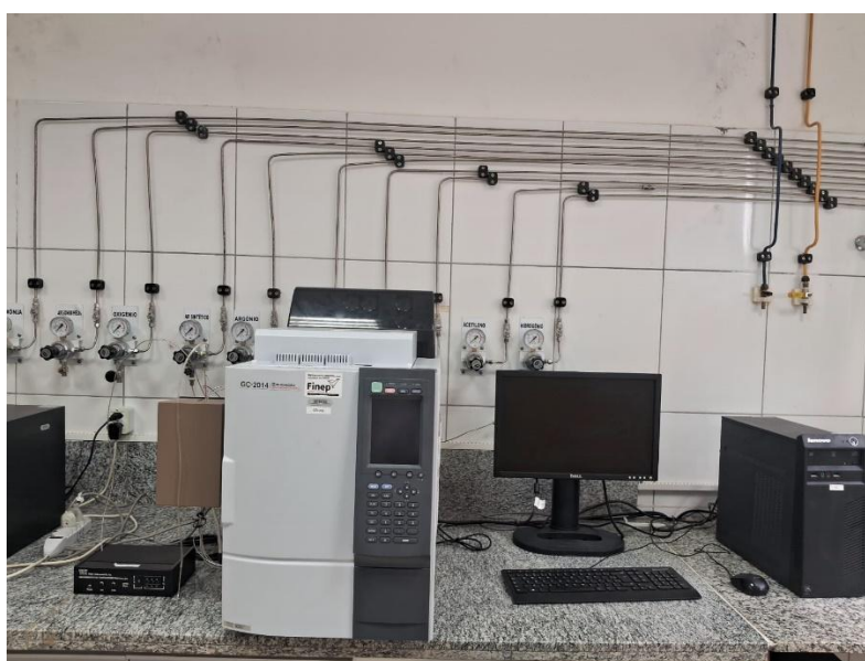
Figura 8- Cromatógrafo gasoso da Shimadzu modelo GC- TCD/FID 2014.
