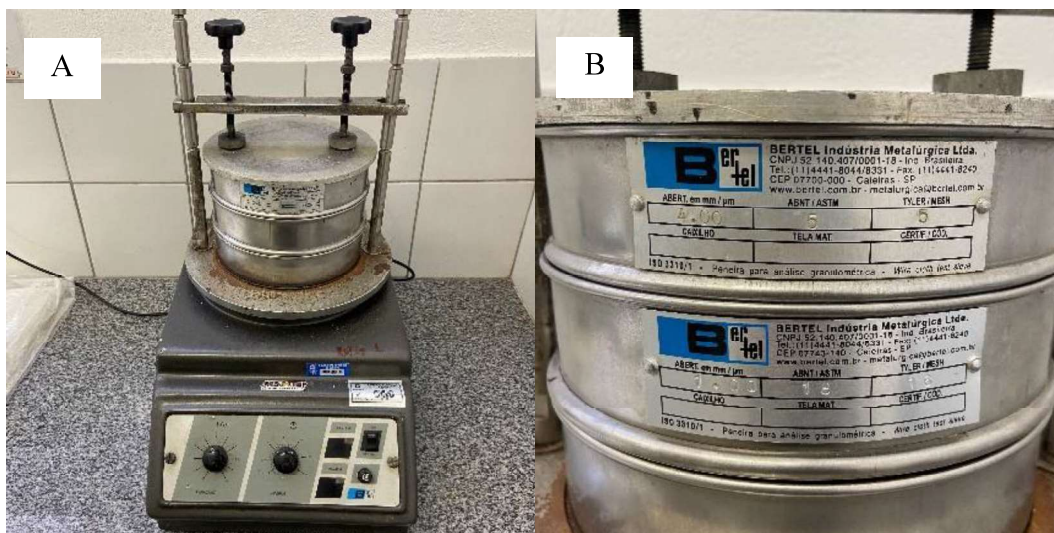
Figura 12. Agitador de Peneiras com Batida Intermitente (A); Peneiras utilizadas (B).
