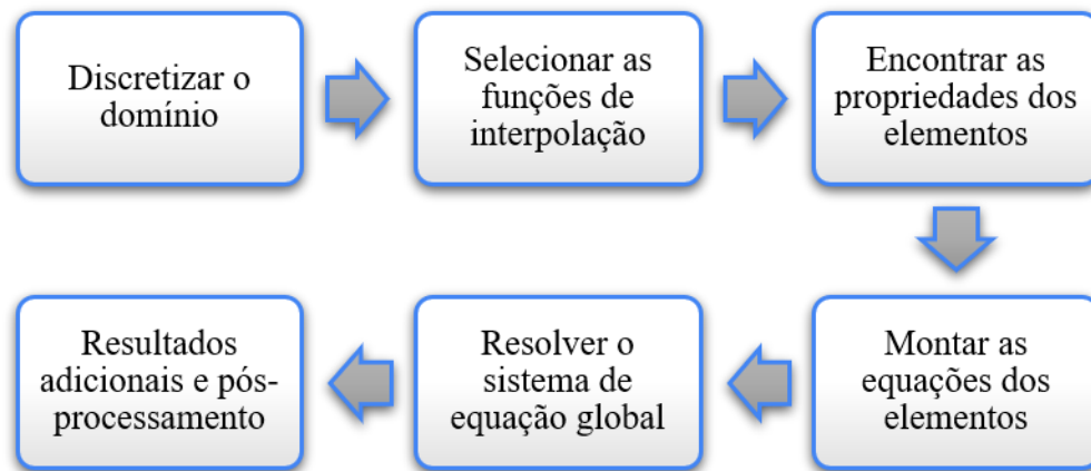
Figura 10: Principais etapas do procedimento de elementos finitos.
