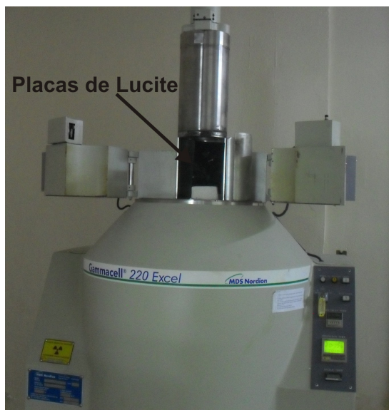
Figura 3.10 – Foto do arranjo experimental de irradiação utilizado no presente trabalho.
