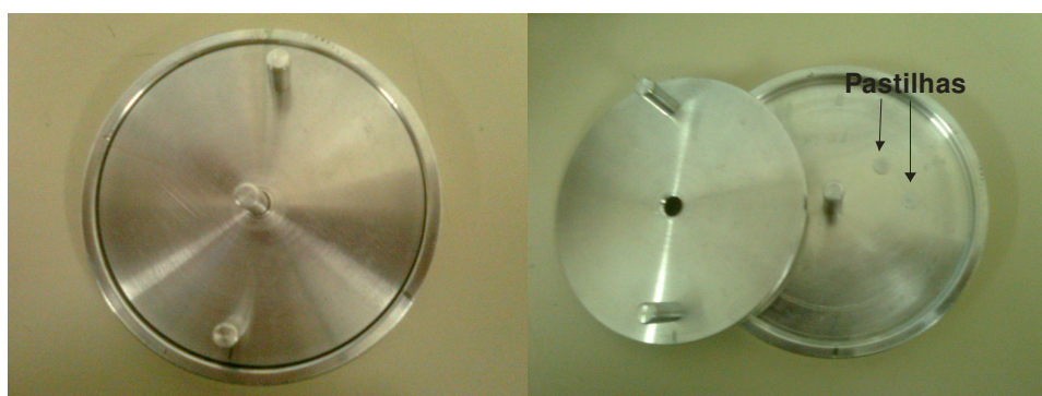
Figura 3.8 – Suporte confeccionado por usinagem convencional para a realização de sinterização.
