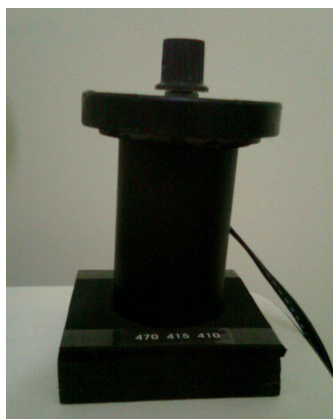
Figura 3.16 – Dispositivo para tratamento óptico das amostras de \alpha\text{-LiAlSi}_2\text{O}_6/\text{Teflon}^\circledR para sua reutilização.
