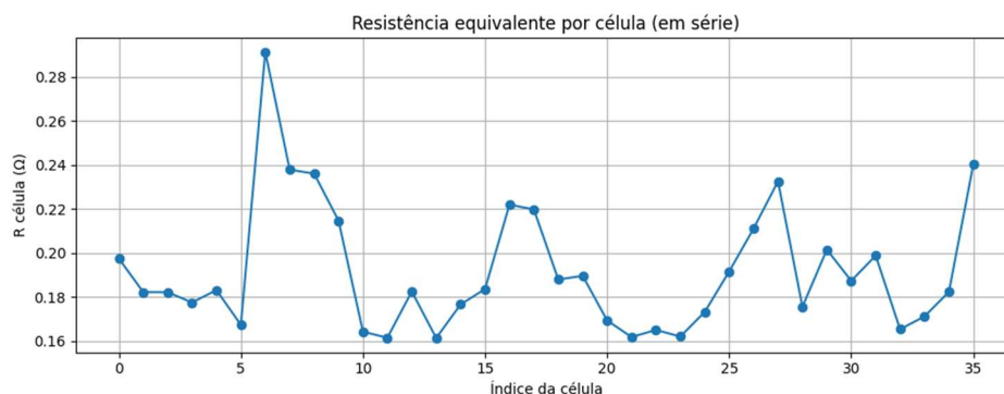
Figura 6.20 Resistência Série Equivalente Por Célula com RS_{mod} = 7,740 \Omega Obtido Através da Inclinação da Curva I-V no Ponto da Tensão de Circuito Aberto ( V_{oc} ). Fonte: Produzida pelo autor.
