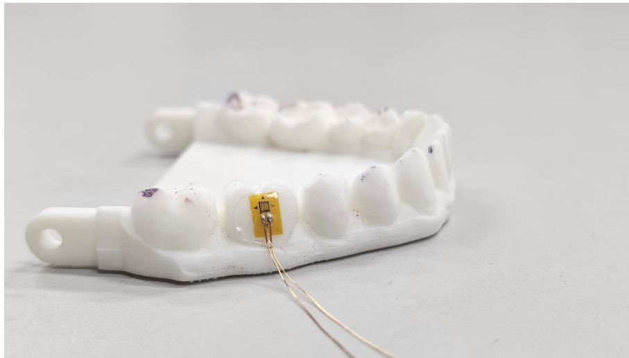
Figura 14 – Modelo de prótese inferior impresso em 3D de resina fotopolimerizável, com o extensômetro fixado na face vestibular do primeiro molar.
