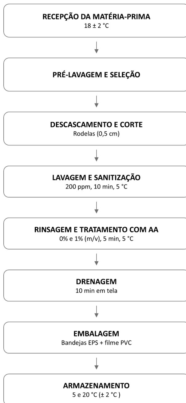
Figura 1. Fluxograma do processamento mínimo do inhame ( Dioscorea cayenensis ) submetido a tratamento com ácido ascórbico e armazenado a 5 °C e 20 °C.
