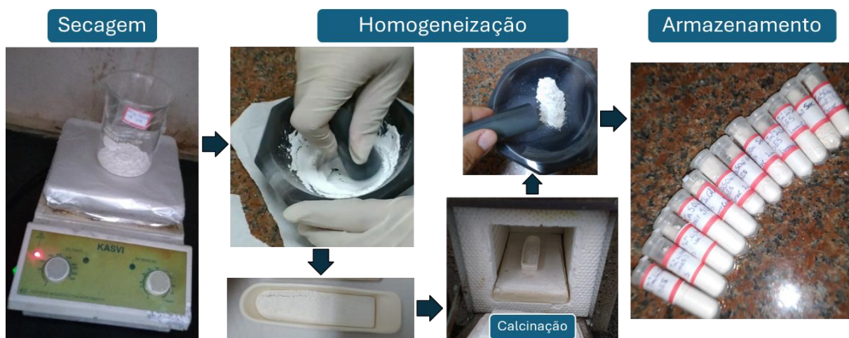
Figura 3.5 - Procedimentos de finalização da preparação dos policristais de \text{CaSO}_4 .
