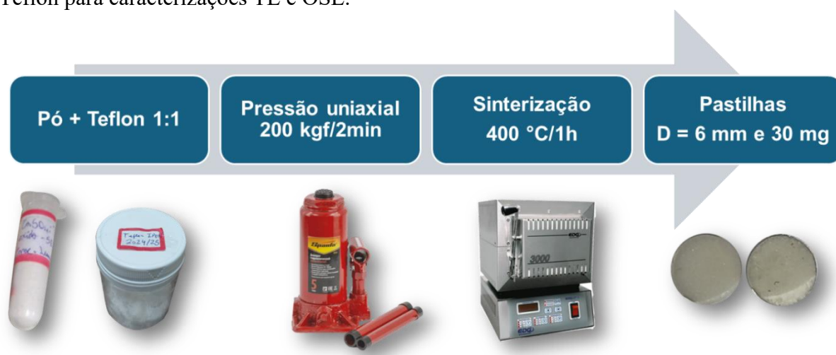
Figura 3.7 - Procedimentos de produção das pastilhas dos policristais de \text{CaSO}_4 com adição de Teflon para caracterizações TL e OSL.
