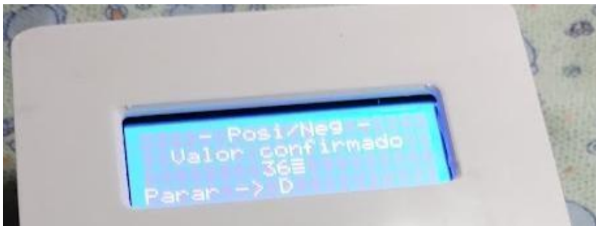
Figura 18: Dispositivo de mobilização em execução e sistema de controle esperando ser pressionado a tecla D para parar
