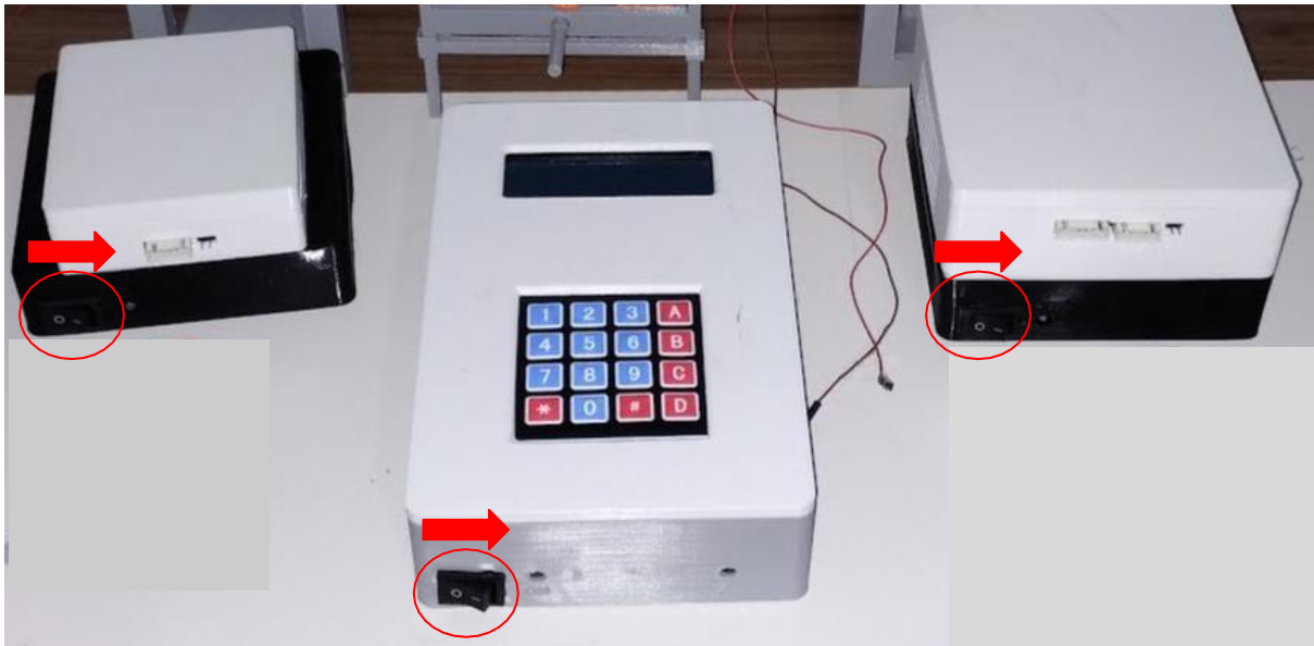
Figura 9: Exibindo os interruptores dos módulos
