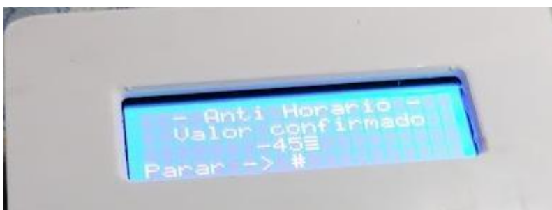
Figura 20: Dispositivo de mobilização em execução e sistema de controle esperando ser pressionado a tecla # para parar
