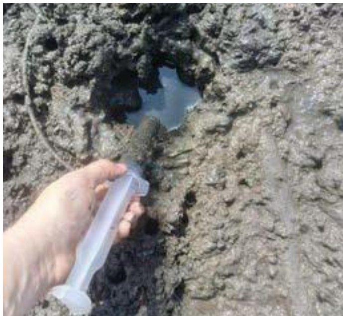
Figura 18. Seringa utilizada para calcular a densidade.
