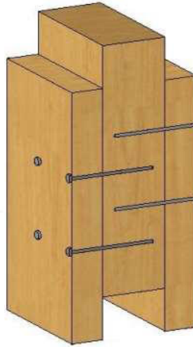
Figura 2 - Estrutura de madeira de seção composta unidas por pinos metálicos.
