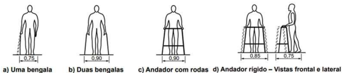
Figura 5 - Dimensões referenciais para deslocamento de pessoas em pé.
