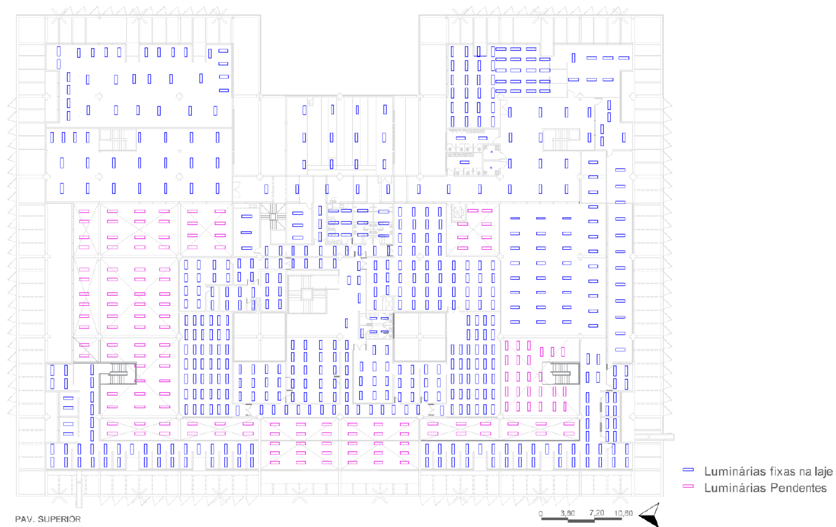
Figura 23 - Layout de luminárias por ambiente da biblioteca, no pavimento superior
