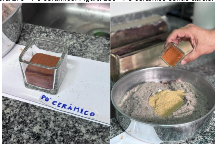
Figura 179 - Pó cerâmico. Figura 180 - Pó cerâmico sendo adicionado.
