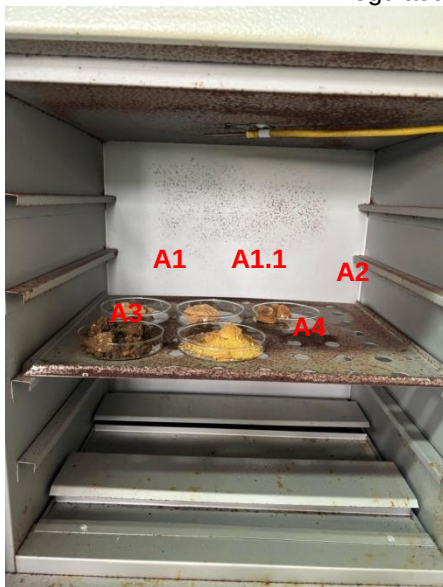
Figura 34 - Amostra A1, A1.1, A2, A3 e A4 colocadas na estufa por 24 horas. Figura 35 - Estufa regulada a 78° C.
