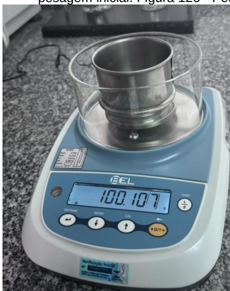
Figura 125 - Pesagem da peneira BERTEL inox 3x 2 malha 16 abert. 1,118 MM, sem amostra – pesagem inicial. Figura 126 - Pesagem do béquer com amostra.
