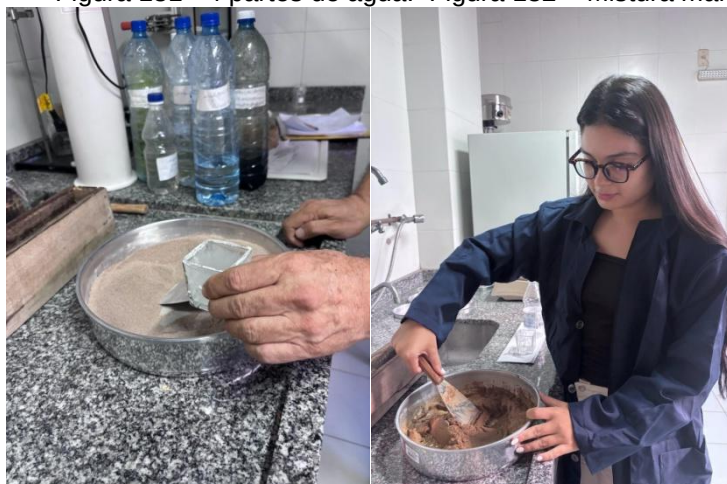
Figura 181 - 4 partes de água. Figura 182 – Mistura manual.
