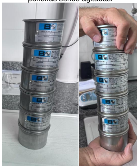
Figura 127 - Jogo de peneiras na posição para início do agitação manual. Figura 128 - Jogo de peneiras sendo agitadas.
