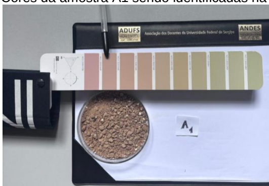
Figura 55 - Cores da amostra A1 sendo identificadas na tabela NCS.
