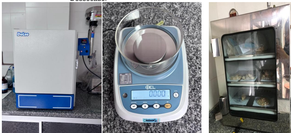
Figura 104 (esquerda) - Estufa. Figura 105 (centro) - Balança de precisão. Figura 106 (esquerda) - Dessecador
