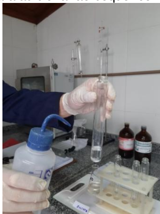
Figura 138 - Sendo medida 100 ml de água deionizada em proveta para lavagem do béquer com 20 ml e 80 ml para adicionar ao béquer com amostra A3.
