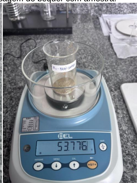
Figura 125 - Pesagem da peneira BERTEL inox 3x 2 malha 16 abert. 1,118 MM, sem amostra – pesagem inicial. Figura 126 - Pesagem do béquer com amostra.
