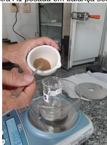
Figura 137 - 10 gramas da amostra A1 pesada em balança semi-análítica em b quer de 100 ml.
