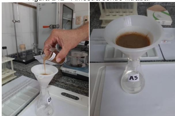
Figura 140 - filtragem da amostra A3 em erlenmayer com auxílio de funil e filtro de papel. Figura 141 - Amostra sendo filtrada.
