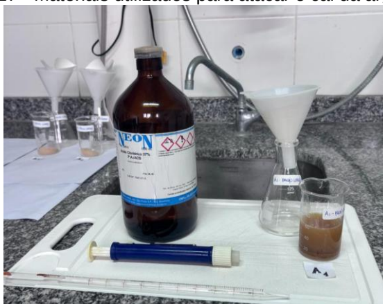
Figura 117 - Materiais utilizados para atacar o cal da argamassa.
