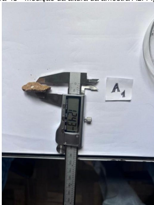
Figura 43 - Medição da altura da amostra A1. Figura 44 - Medição da largura da amostra A1.
