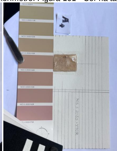
Figura 100 - Identificação da cor da amostra A4 com colorímetro. Figura 101 - Cor na tabela NCS.
