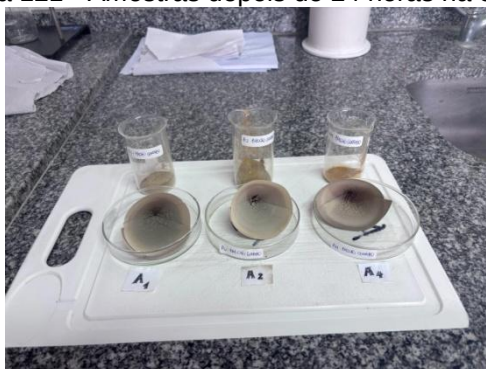
Figura 121 - Amostras depois de 24 horas na estufa.
