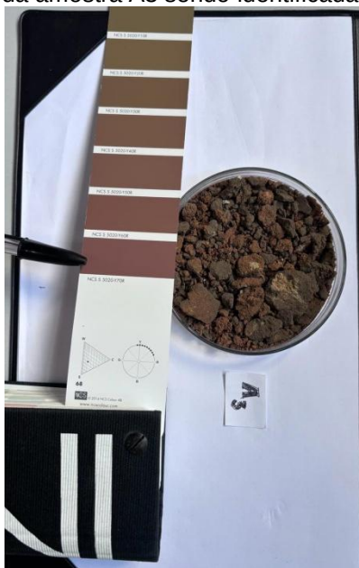
Figura 87 - Cores da amostra A3 sendo identificadas com tabela NCS.
