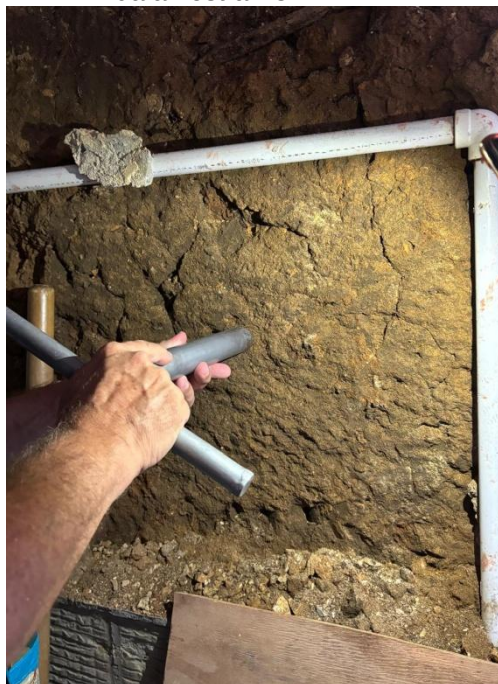
Figura 20 - Extração da amostra A3 utilizando extrator manual; Figura 21 - Localização da extração da amostra A3.
