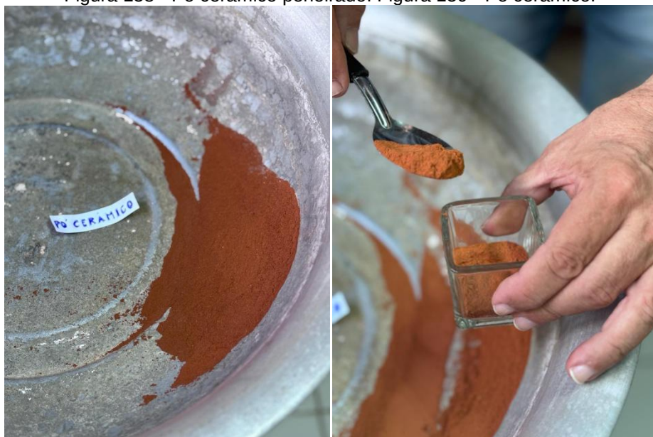
Figura 158 - Pó cerâmico peneirado. Figura 159 - Pó cerâmico.
