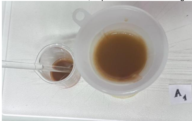
Figura 118 - A sendo filtrada, separando os finos dos grossos.
