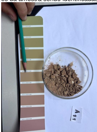
Figura 68 - Cores da amostra sendo identificadas na tabela NCS.
