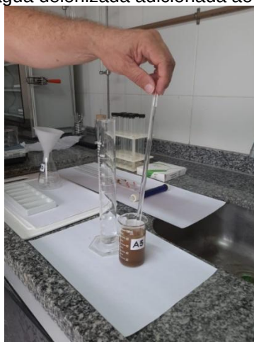
Figura 139 - 100 ml de água deionizada adicionada ao béquer com amostra A3.
