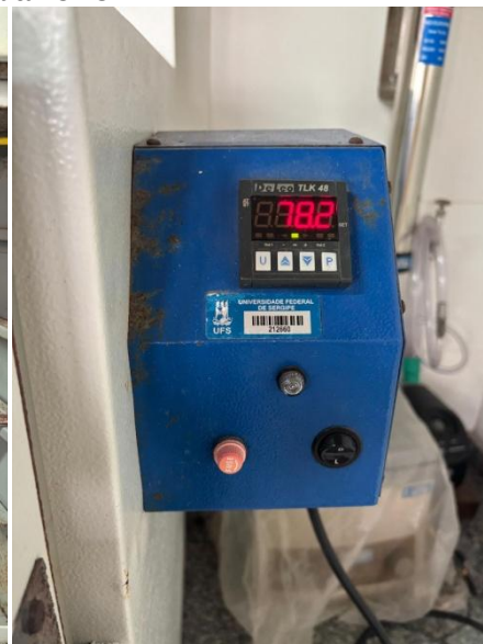
Figura 34 - Amostra A1, A1.1, A2, A3 e A4 colocadas na estufa por 24 horas. Figura 35 - Estufa regulada a 78° C.
