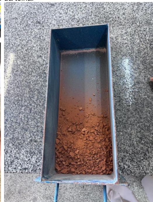
Figura 152 - Telha triturada na Gaveta coletora de material. Figura 153 - Primeiro processo de trituração da telha.
