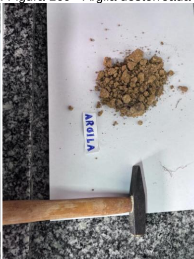
Figura 168 - Argila antes de ser destorroada. Figura 169 - Argila destorroada com martelo.
