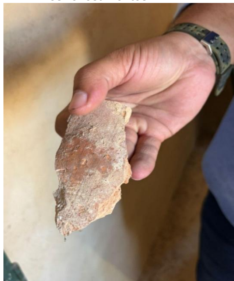
Figura 28 - Fragmento cerâmico coletado no Sobrado do Balcão Corrido, indicando presença de telha nos revestimentos.
