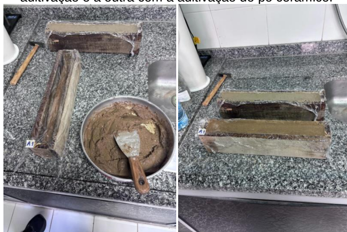
Figura 183 - Argamassa sendo passada para forma de madeira. Figura 184 - Argamassa sem aditivação e a outra com a aditivação do pó cerâmico.
