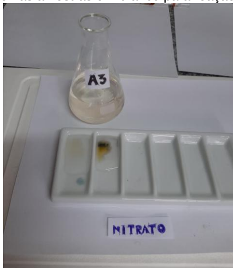
Figura 142 - Foram pingadas três gotas de difenilamina a 1% de ácidosulfúrico nas amostras filtradas e nas amostras em branco para reação.
