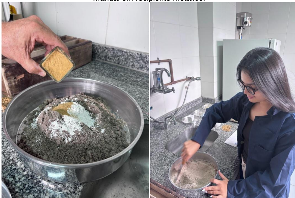
Figura 172 - doze partes de arenoso, uma parte de Cal e uma parte de argila. Figura 173 – Mistura manual em recipiente metálico.
