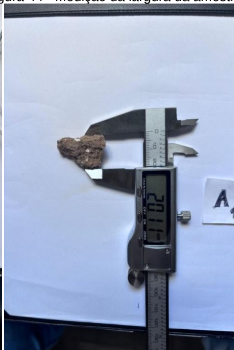
Figura 43 - Medição da altura da amostra A1. Figura 44 - Medição da largura da amostra A1.
