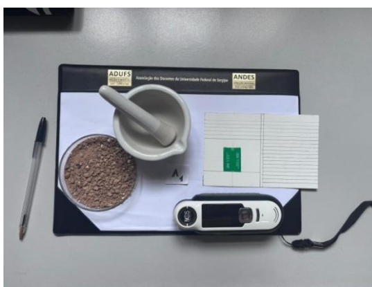
Figura 56 - Materiais utilizados para identificação das cores das amostras com colorímetro.
