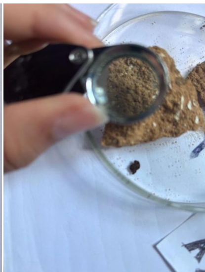
Figura 41 - Amostra A1 antes de ser destorroada. Figura 42 - Amostra A1 sendo analisada por lupa de joalheiro
