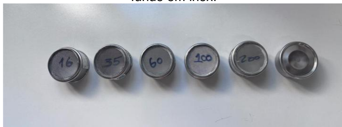
Figura 124 - Jogo de peneiras BERTEL inox 3 x 2 malha 16 abert. 1,118 MM; malha 35/32 abert. 0,500 MM; malha 60 abert. 0,250 MM; malha 100 abert. 0,150; malha 200 abert. 0,075 MM; tampa e fundo em inox.
