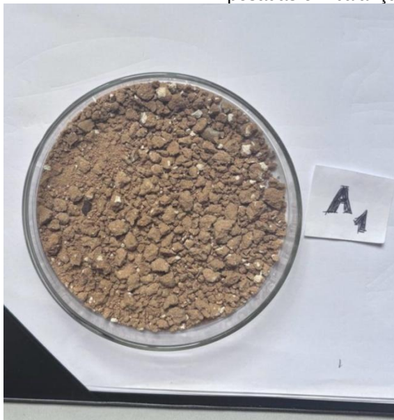
Figura 32 - Amostra A1 úmida em Placa Petri. Figura 33 - Amostra A1 úmida mais Placa Petri sendo pesadas em balança de precisão.
