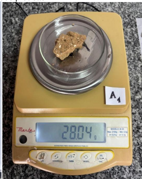
Figura 32 - Amostra A1 úmida em Placa Petri. Figura 33 - Amostra A1 úmida mais Placa Petri sendo pesadas em balança de precisão.
