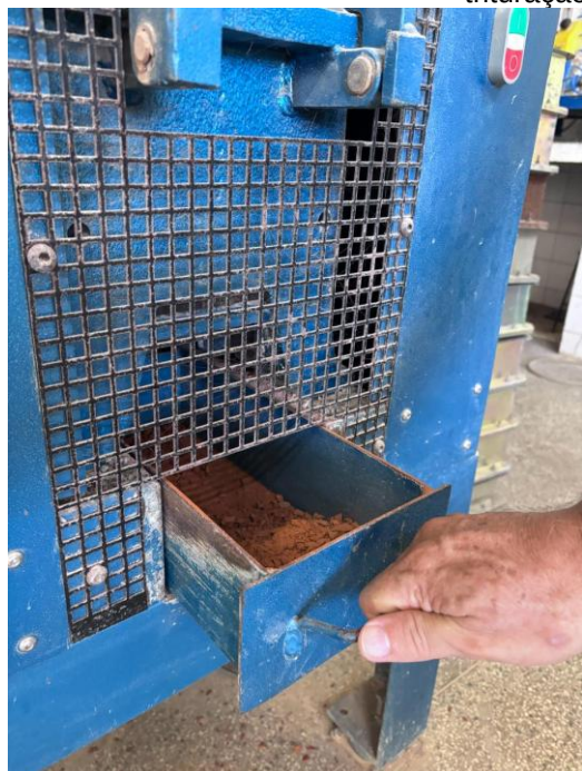
Figura 152 - Telha triturada na Gaveta coletora de material. Figura 153 - Primeiro processo de trituração da telha.
