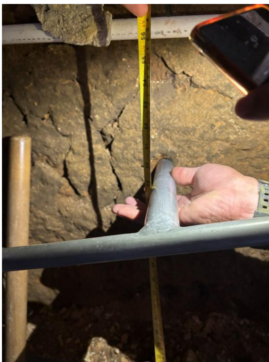
Figura 13 - Extrator manual, utilizado para a extração das amostras no Sobrado do Balcão Corrido.
