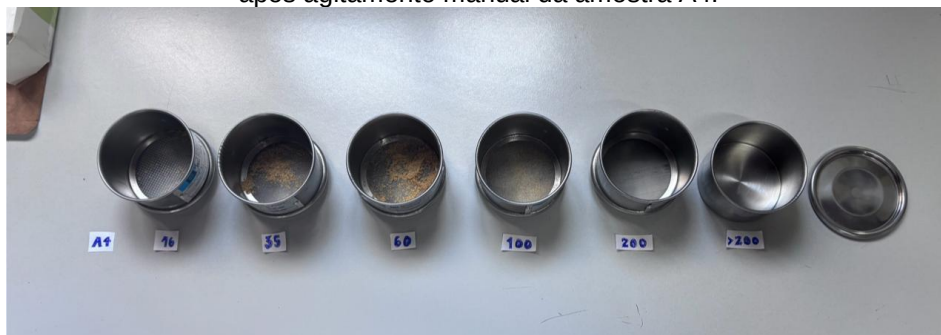
Figura 133 - (da esquerda para direita) Resíduos retidos nas peneiras Nº 16; 35; 60; 100; 200 e > 200 após agitação manual da amostra A4.
