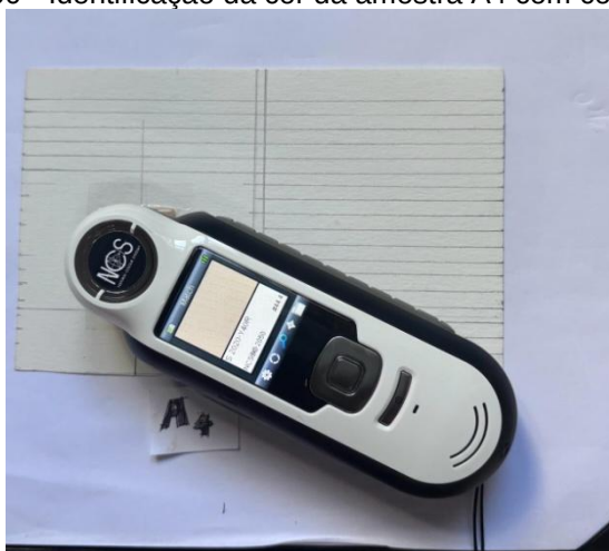
Figura 100 - Identificação da cor da amostra A4 com colorímetro. Figura 101 - Cor na tabela NCS.
