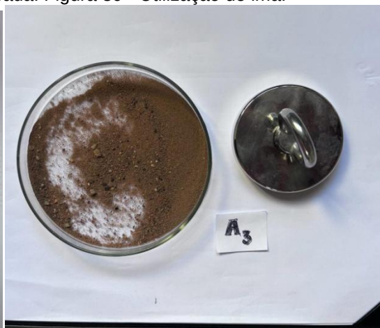
Figura 88 - Amostra A3 destorroada. Figura 89 - Utilização de imã.
