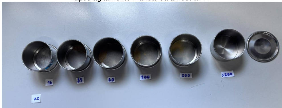
Figura 132 - (da esquerda para direita) Resíduos retidos nas peneiras Nº 16; 35; 60; 100; 200 e > 200 após agitação manual da amostra A2.
