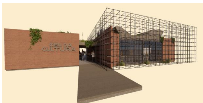
Figura 23 – Grid metálico na fachada do CEU
