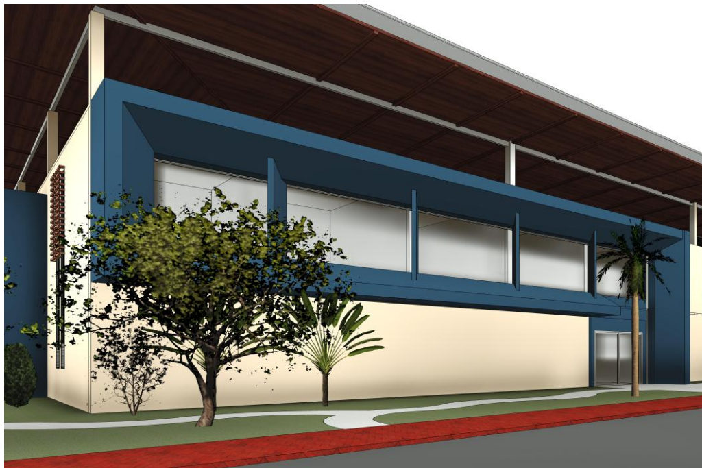
Figura 53 – Brise Fachada Leste
