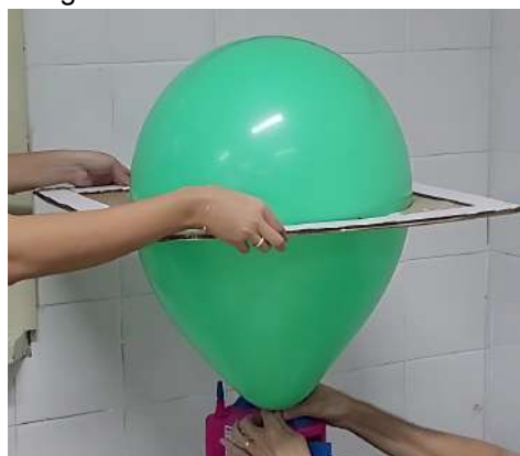
Figura 47 - Bexiga de látex nº 16 e molde de 45 cm de diâmetro
