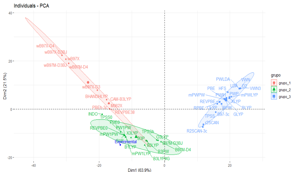
Figura 20. Gráfico do PCA para os espectros de absorção TDDFT e INDO/S-CIS, com a projeção dos dados experimentais no espaço do PCA.
