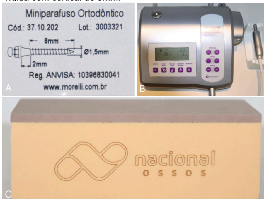
Figura 1. A- Referência do mini-implante utilizado. B- Motor cirúrgico Neosurg XT Plus, utilizado para aferição do torque máximo de inserção e remoção, com configuração inicial de inserção. C- Corpo de prova Nacional Ossos em espuma rígida com cortical de 3mm.
