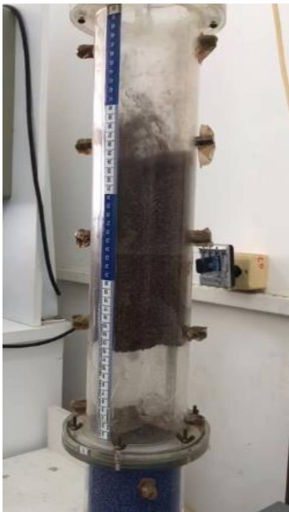
Figura 4.6 - Escoamento do tipo slug para biomassa com X_{bu} = 75\% e L/D = 2 .
