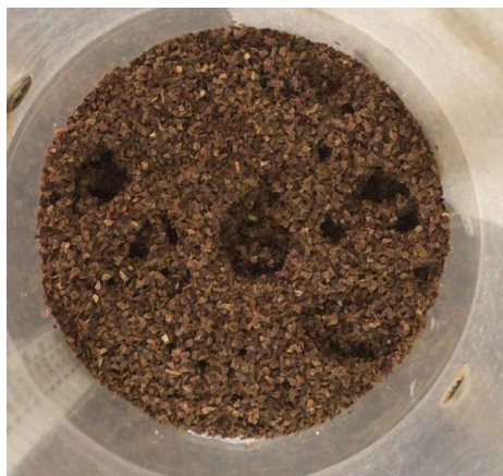
Figura 4.24 - Caminho preferencial observado após ensaio com a mistura binária composta por biomassa de X_{bu} = 75\% e x_v = 50\% , e areia de 0,93 mm de diâmetro.
