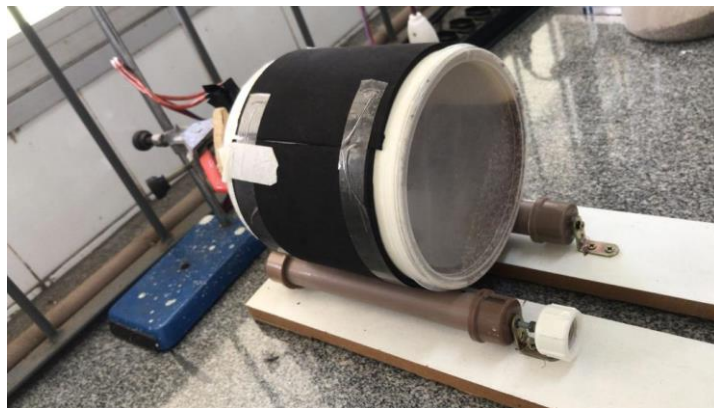
Figura 3.5 - Tambor rotativo utilizado para determinação do ângulo de repouso.
