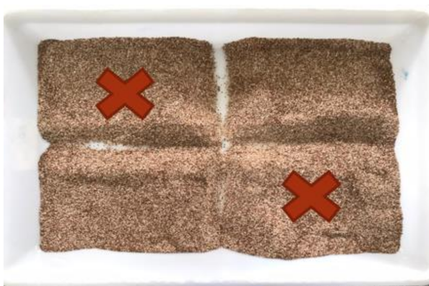
Figura 3.6 - Quarteamento para homogeneização e seleção de amostras.
