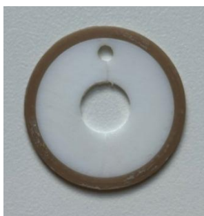
Figura 1: Matriz de teflon bipartida com 8 mm de diâmetro x 1 mm de espessura para confecção dos espécimes.
