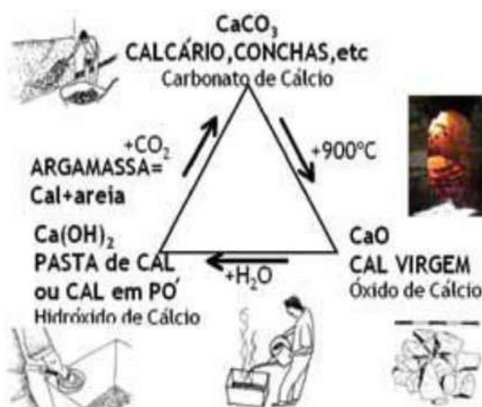
Figura 1: Ciclo da cal responsável por conferir resistência às argamassas.
