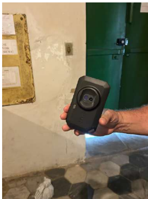
Figura 73: Câmera Termográfica FLIR C5, utilizada para ensaio termográfico na Igreja Matriz.
