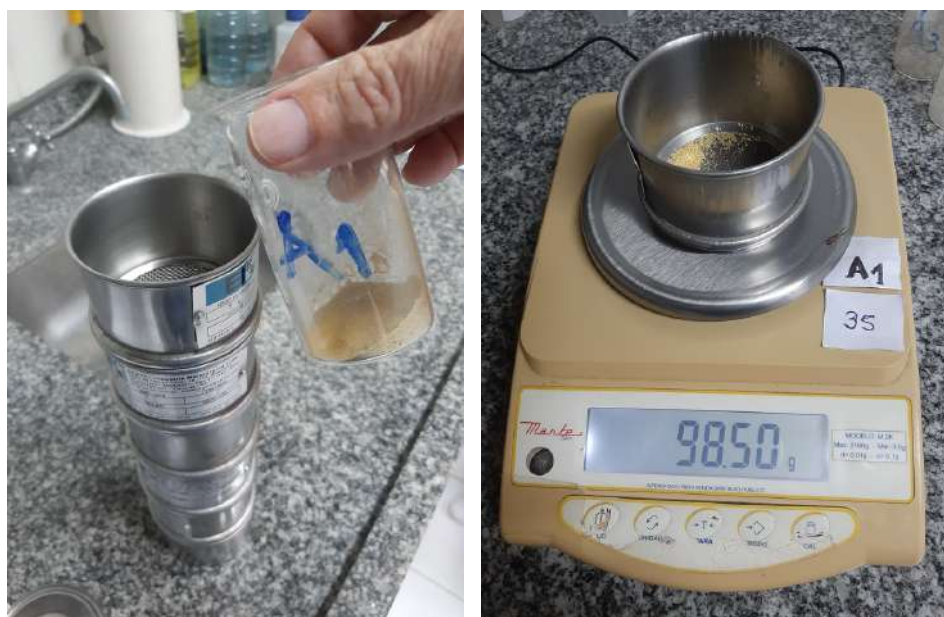
Figura 11 (esquerda): Peneiras usadas para o ensaio de análise granulométrica. Figura 12 (direita): Procedimento de pesagem da peneira com amostra retida.
