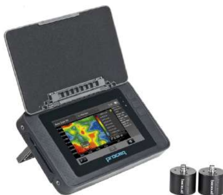
Figura 25: Equipamento Pundit Ultrasonic Pundit 200 da empresa PROCEQ.
