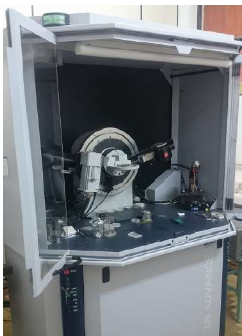
Figura 9: Difrator de raios-X para análise de amostras em pó ou filmes finos do laboratório da UFSM.
