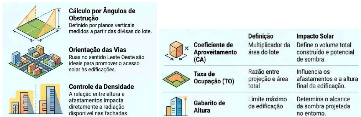
Figura 7 - Parâmetros Urbanísticos com potencial de interferência no acesso solar; Descrição dos parâmetros urbanísticos (à esquerda) e Aplicação dos parâmetros urbanísticos (à direita).
