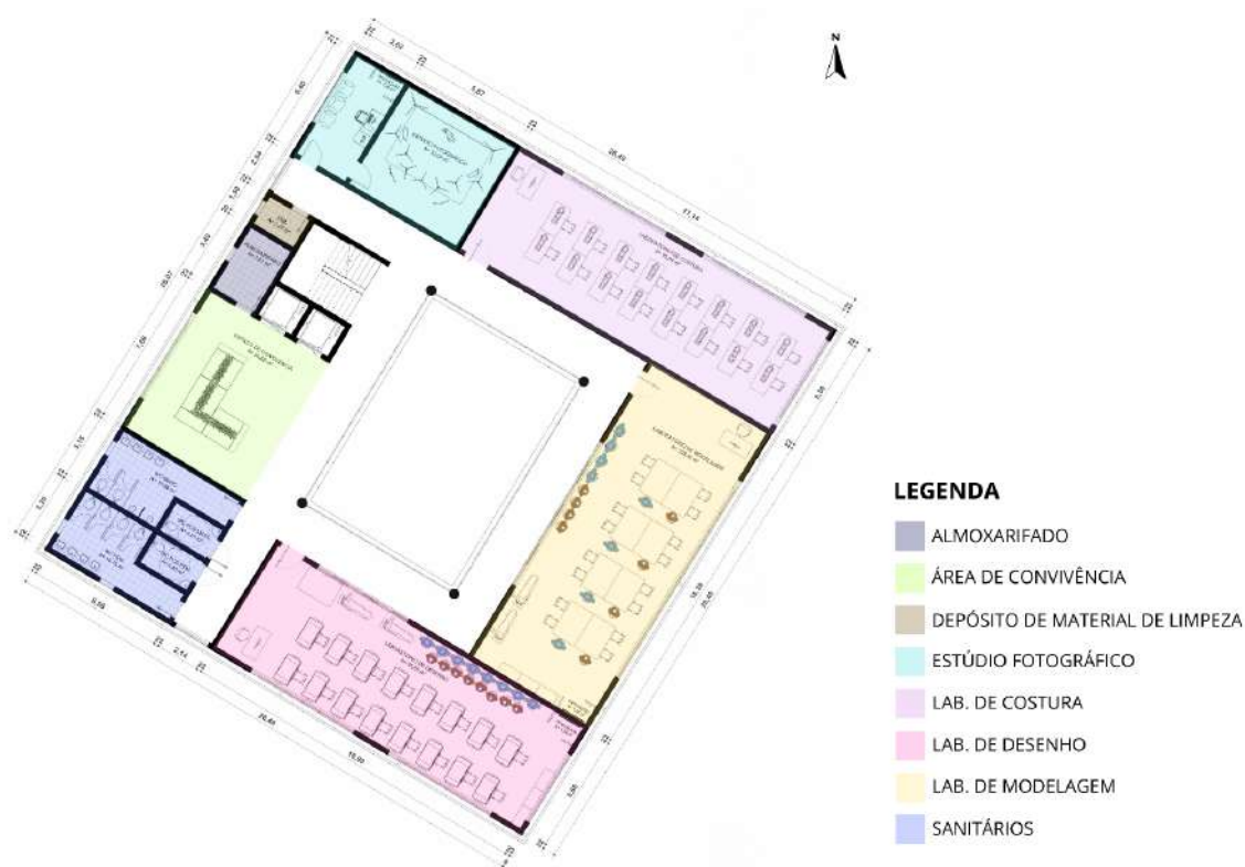
Figura 70 - Planta baixa terceiro pavimento.
