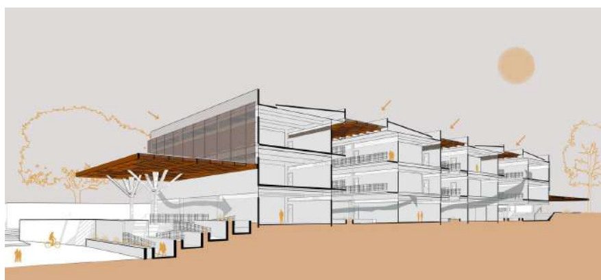
Figura 33 - Corte perspectivado de circulação.
