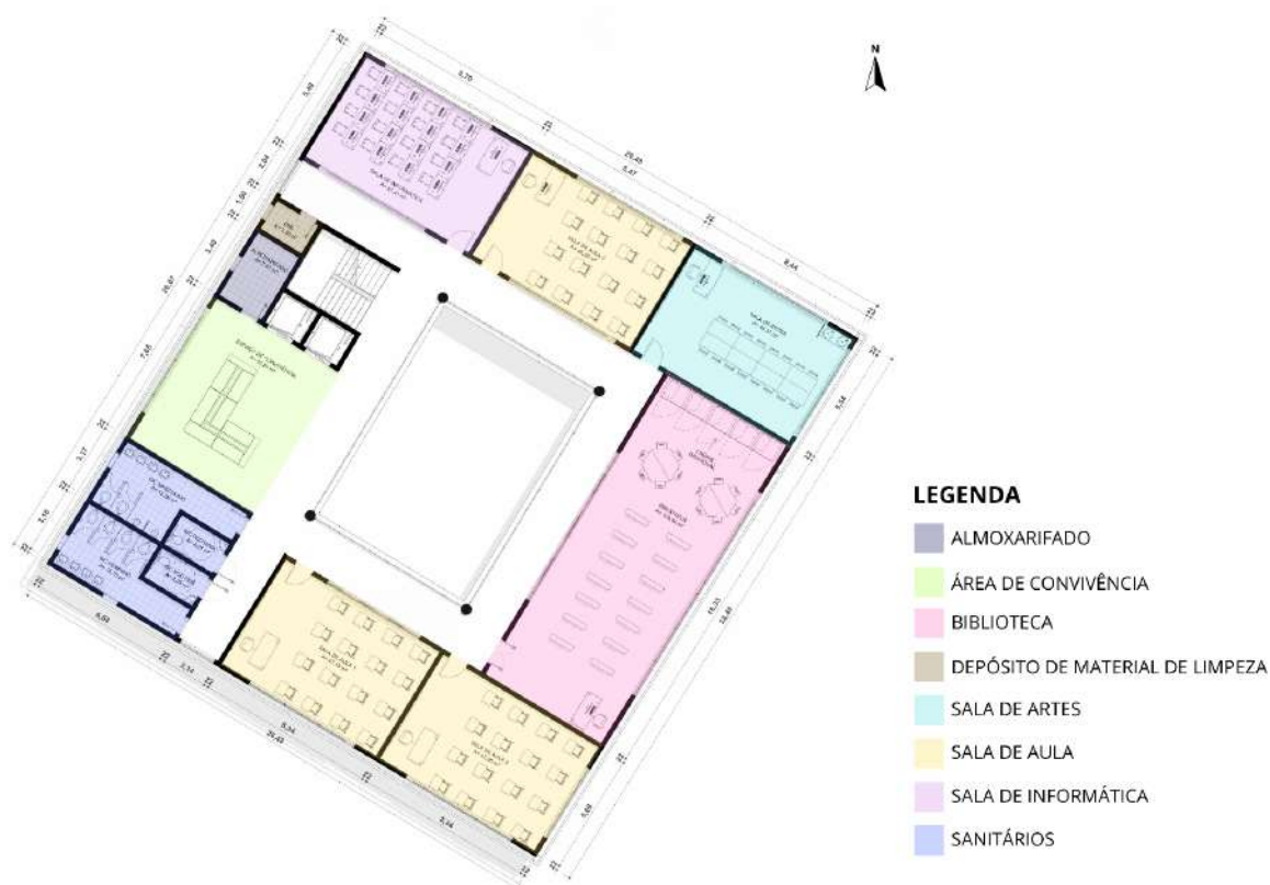
Figura 69 - Planta baixa segundo pavimento.
