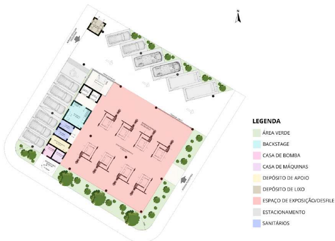
Figura 67 - Planta baixa pavimento térreo.
