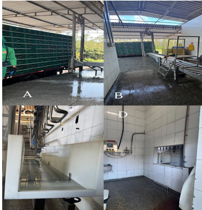
Figura 3: Início do processo do manejo pré-abate. A. Plataforma de recepção com caminhão carregado de caixas plásticas verdes utilizadas para o transporte de aves vivas B. Esteira transportadora mecânica de roletes C. Área interna da pendura e atordoamento com os ganchos metálicos D. Sala de sangria.
