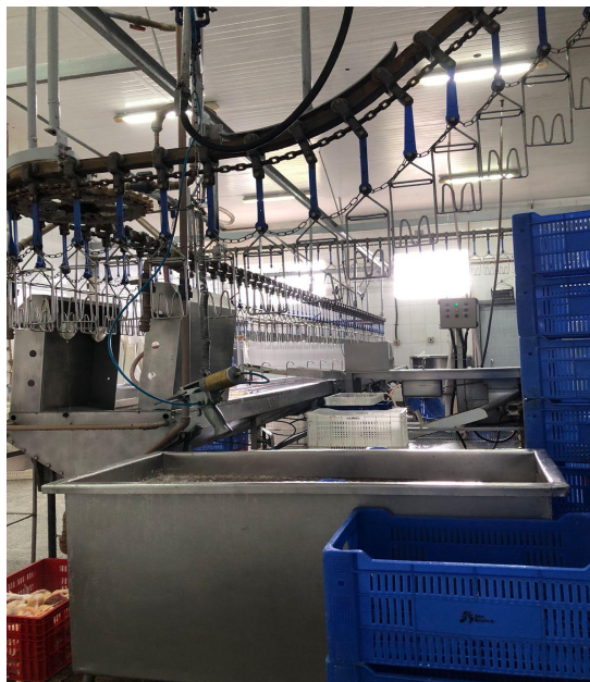
Figura 6: Visão da linha de evisceração, chiller de pescoço e máquina da moela. Fonte: Arquivo pessoal.
