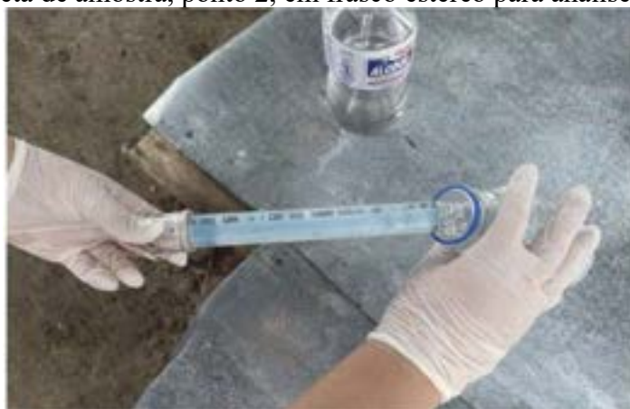
Figura 21 - Coleta de amostra, ponto 2, em frasco estéril para análise Microbiológica
