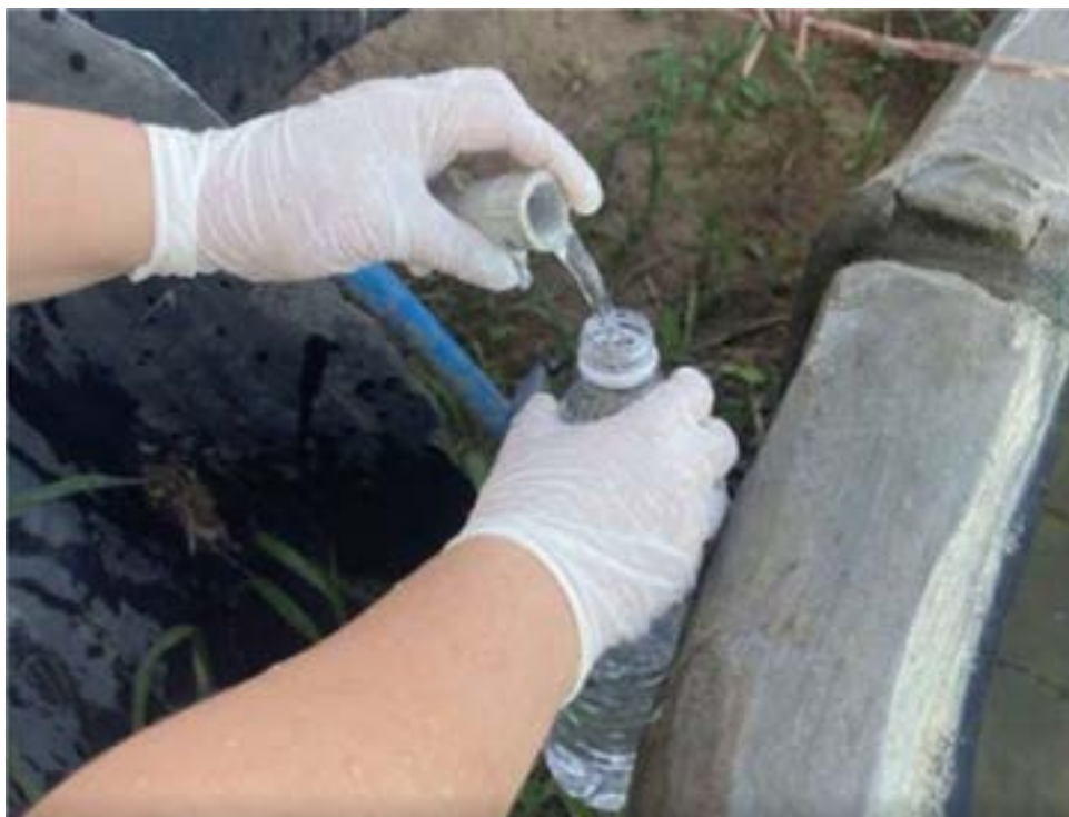
Figura 15 - Amostra ponto 1 em frasco de plástico de 1000ml para análise físico-químicos
