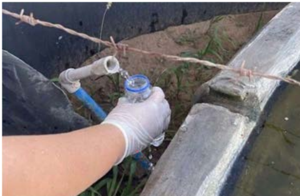
Figura 14 - Amostra ponto 1 em frasco estéril para análise Microbiológica
