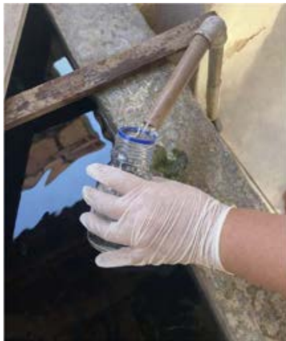
Figura 18 - Coleta de mostra, ponto 2, em frasco estéreo para análise Microbiológica
