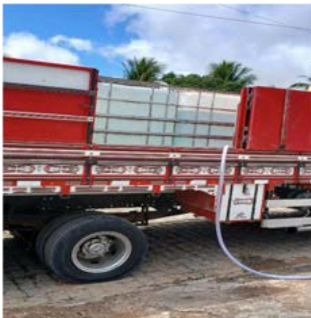
Figura 27- Reservatórios plásticos, instalados sobre caminhões para transporte de água
