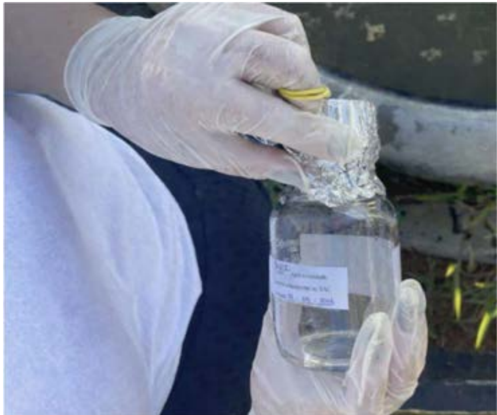
Figura 13 - Frasco estéril de boca larga - 200ml para amostra ponto 1
