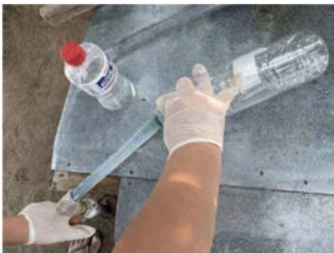
Figura 22 - Coleta de amostra, ponto 3, em frasco de plástico de 1000ml para análise físico-químicos
