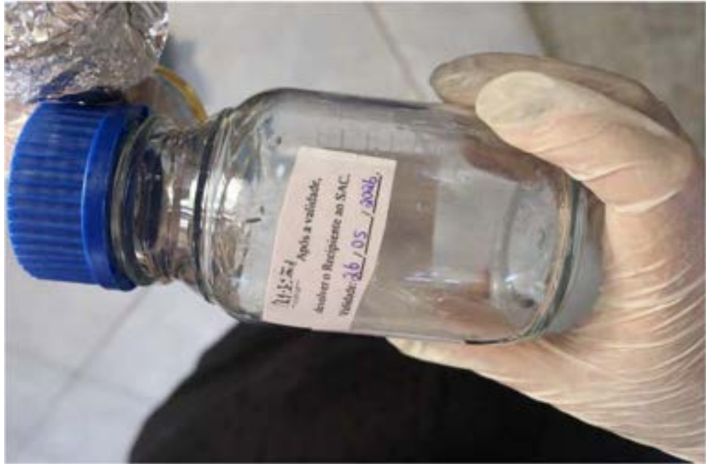
Figura 17 - Frasco estéreo de boca larga - 200ml para amostra ponto 2
