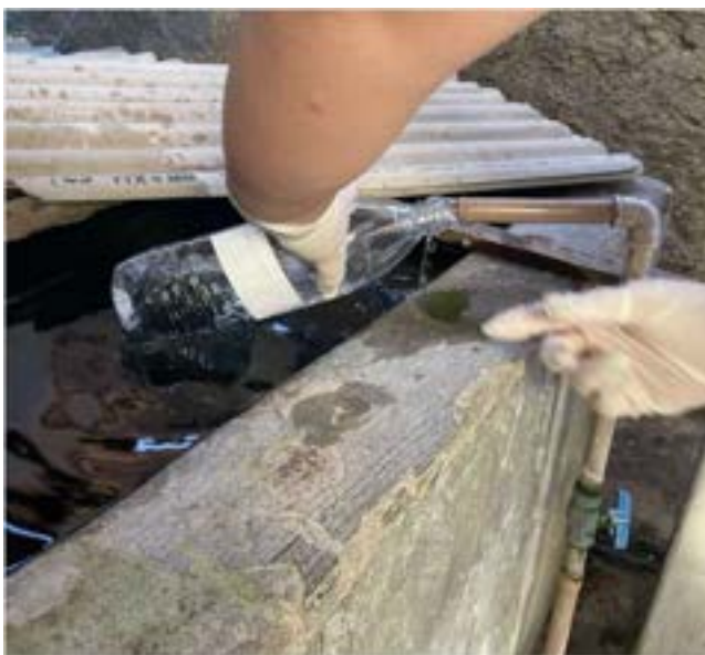
Figura 19 - Coleta de amostra, ponto 2, em frasco de plástico de 1000ml para análise físico-químicos
