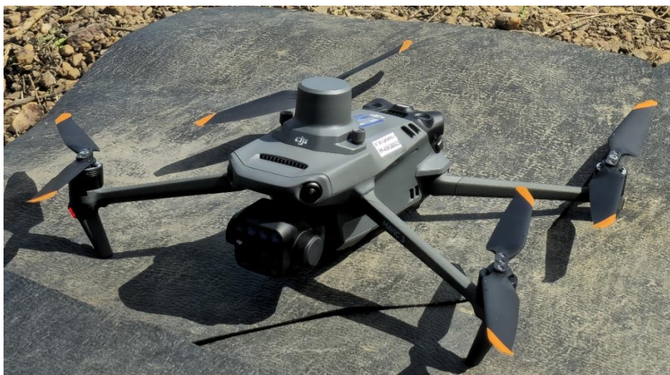
Figura 2. Drone DJI Mavic 3M utilizado no levantamento aerofotogramétrico. (Fonte: Autor, 2024).
