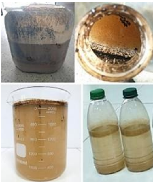
Figura 128 - Recipientes com óleos, graxas e sólidos retidos nas paredes.
