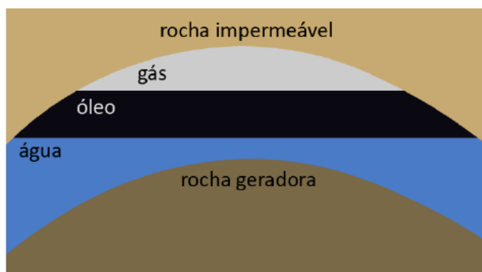
Figura 1- Design típico de um reservatório de petróleo e gás natural
