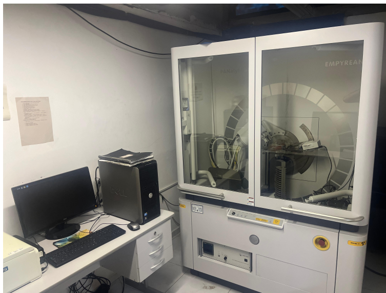
Figura 3.3: Equipamento utilizado para as medidas de difração de raios X. Difratômetro Empyrean Panalytical com configuração Bragg-Brentano.
