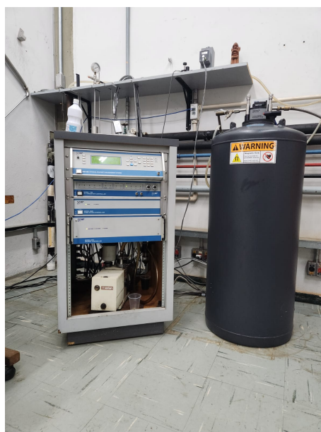
Figura 3.7: PPMS utilizado para medições de calor específico e resistividade elétrica dos compostos analisados.
