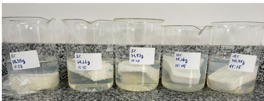
Figura 4. Teste de absorção de água dos sabões com leite de cabra
