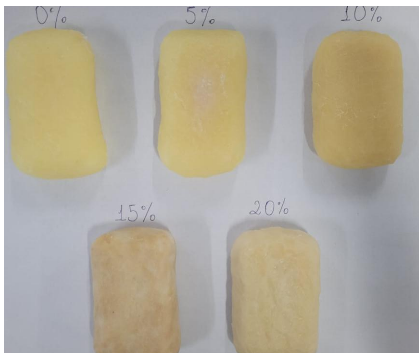
Figura 11. Aspecto dos sabões após o teste de perda de massa
