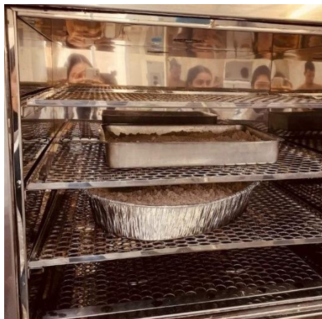
Figura 3. Ilustração da secagem da areia lavada em estufa de circulação de ar à 105° C por 72 horas, para a esterilização do material. (Fonte: Arquivo pessoal, 2025).
