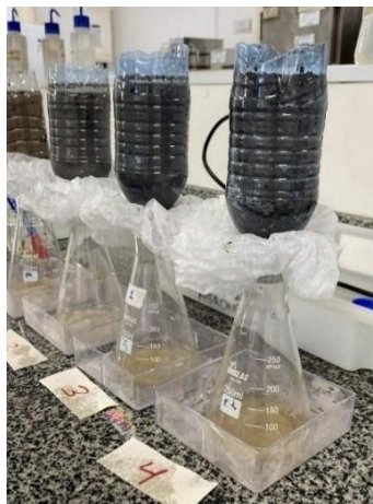
Figura 4. Imagem do teste de capacidade de retenção de água no solo, obtido por lisimetria de drenagem (Fonte: Arquivo pessoal, 2025).
